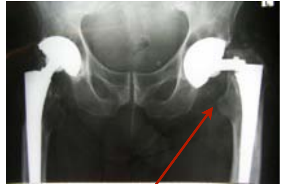
Fatigue Fx. titanium neck
