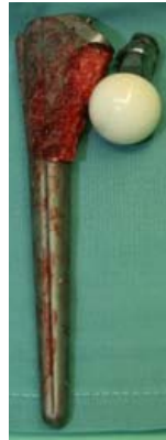
Fatigue Fx. titanium neck
