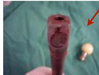
Fatigue Fx. titanium neck
